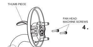
AFTER INSTALLATION DEPRESS THUMB LEVER TO ENSURE OPERATION IS SMOOTH AND SPINDLE HUB ROTATES.
